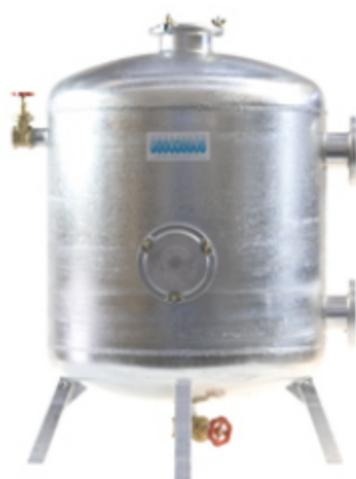
Ce filtre est recommandable surtout pour les installations à goutte avec prélèvement de l'eau des fleuves, des petits lacs de colline ou pourrissoirs. Il vient installé devant le filtre à écran. Il consiste en un réservoir d'acier galvanisé, situé en position perpendiculaire contenant gravier volcanique ou fragments de marbre lavé, de grandeur de mm. 1 e mm. 3.
