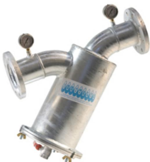
Ce type de filtre est un des plus simplex des diverses techniques de filtrage pour installation à goutte et installations mobiles d'arrosage. Est construit entièrement en acier galvanisé, formé d'un réservoir cylindrique avec à l'intérieur une cartouche filtrante de crible différent selon le type d'eau à filtrer ou du type d'installation.
