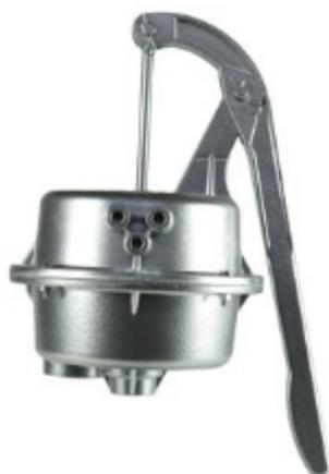
Vient utilisée pour le remplissage d'eau dans la pompe horizontale, actionnant le levier spécial, on consente d'évacuer l'air du tube d'aspiration, permettant automatiquement le remplissage de la pompe.
