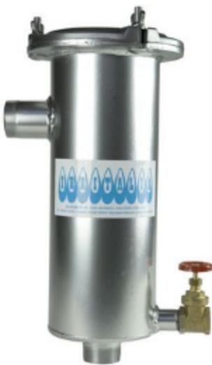
Ce type de filtre est le plus simple des techniques de filtration pour installations à goutte. Il consiste en un réservoir d'acier galvanisé sur lesquels sont situés deux écrans cylindriques, l'un avec crible filtrant de 80 mesh qui sert à filtrer l'eau des particules les plus grossières, l'autre avec crible filtrant de 125 mesh pour les particules plus fines.
