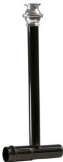
Employé pour la liaison des conduites fixes enterrées en PVC ou fibre de ciment, avec les conduites mobiles volantes. Est constitué à TEE en acier du diamètre correspondant aux tubes des conduits enterrés avec colonnette verticale en acier de la hauteur voulue, à la sommité de laquelle est prévu un filetage Gas unifié pour visser la tête de vanne.
